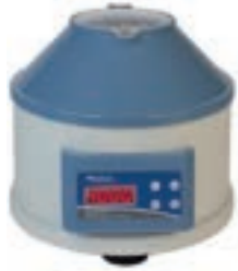
REF.1187GBF001 Centrífuga angular digital 2615/1, 6 x 15 ml Con capacidad para 6 tubos de 15 ml
